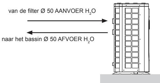
Installeer een bypassklep tussen de aanvoer en de afvoer van de warmtepomp.
