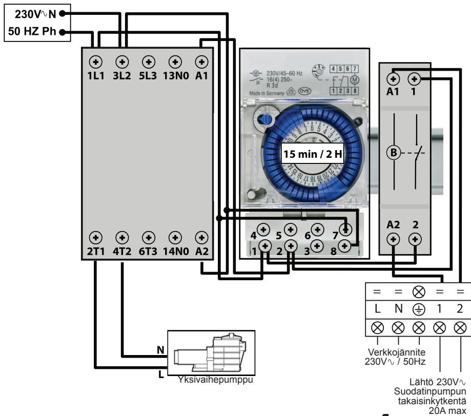
Silloin, kun suodatinpumppua ei käytetä jatkuvasti, veden lämpötilaa pitää tarkkailla käynnistämällä suodatinpumppu säännöllisin väliajoin (15 minuutin ajaksi joka toinen tunti). Jos näiden tarkkailujaksojen aikana havaitaan, että vettä täytyy lämmittää, lämpöpumppu käynnisty.
