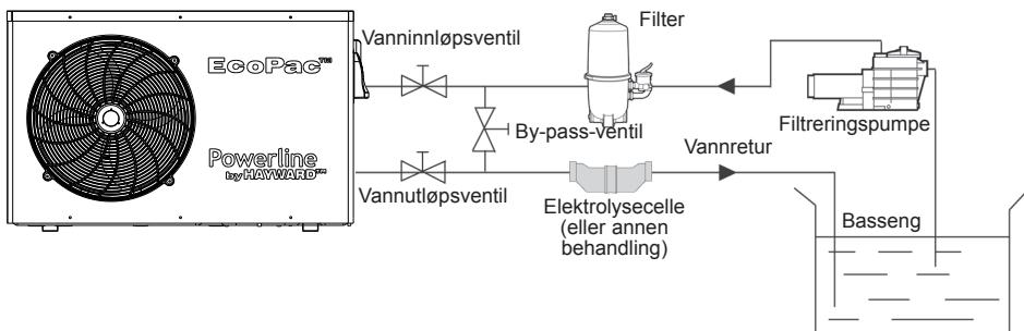
Merk: Varmepumpen leveres uten noe rense- eller filtreringsutstyr.
