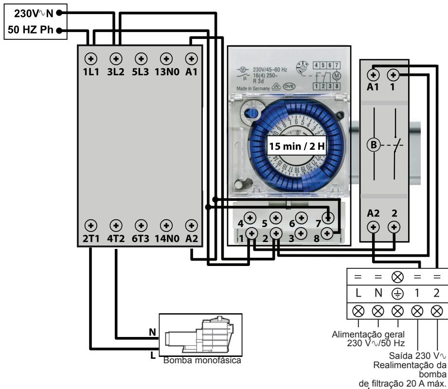
Fora da gama de filtração, é necessário proceder a uma análise da temperatura da água o arranque regular da bomba de filtração (15 min. em cada 2 horas). Se, no decurso deste período de análise, a bomba de aquecimento estiver em solicitação, esta arranca e mantém a prioridade de aquecimento.
