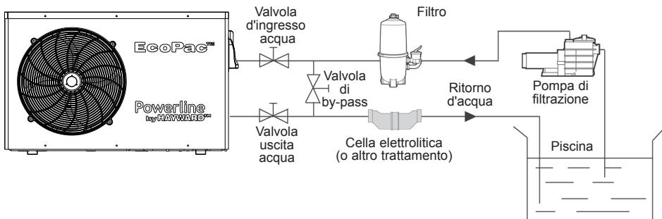
Nota: La pompa di calore viene fornita priva di dispositivo di trattamento o di filtrazione. I componenti indicati sullo schema sono forniti dall'installatore.
