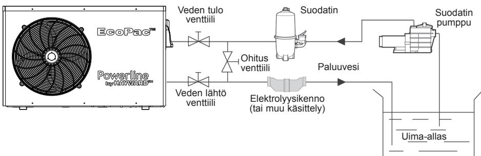
Huomaa:Lämpöpumppu toimitetaan ilman veden käsittely- tai suodatuslaitteita. Asentajan on hankittava kaaviossa esitettyt osat.
