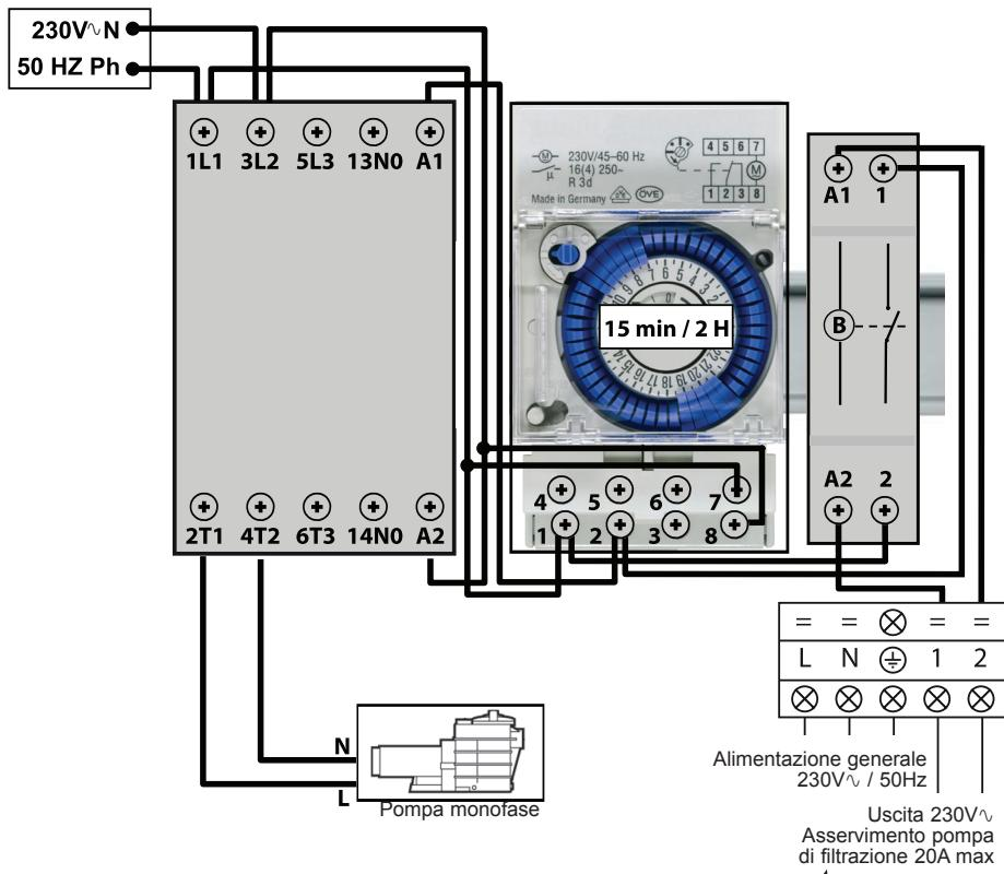
Filtrazione non valida, è necessario avviare un'interrogazione della temperatura dell'acqua mediante attivazione regolare della pompa di filtrazione (15 minuti ogni 2 ore). Se durante questo periodo la pompa di calore è in fase di domanda, la pompa si attiverà e manterrà la priorità riscaldamento.
