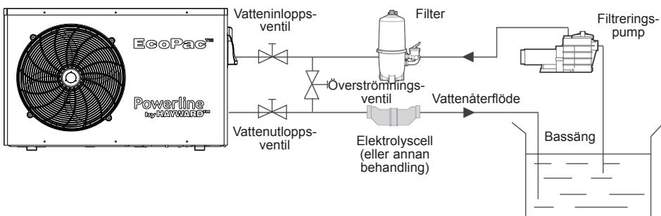
Anmärkning: Värmepumpen levereras utan någon behandlings- eller filtreringsutrustning. Elementen som visas på schemat är delar som installatören måste tillhandahålla.
