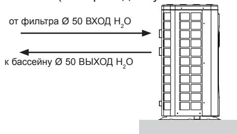
Установите так называемый «перепускной» клапан между входным и выходным отверстиями теплового насоса.
