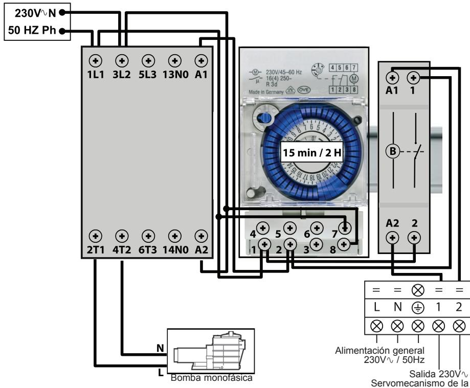
Excepto en la zona de filtración, es necesario examinar la temperatura del agua mediante poniendo en funcionamiento la bomba de filtración regularmente (15 minutos cada 2 horas). Si durante este periodo de examen de la temperatura se determina que es necesario activar la bomba de calor, ésta se pondrá en funcionamiento y mantendrá la prioridad de calentamiento.
