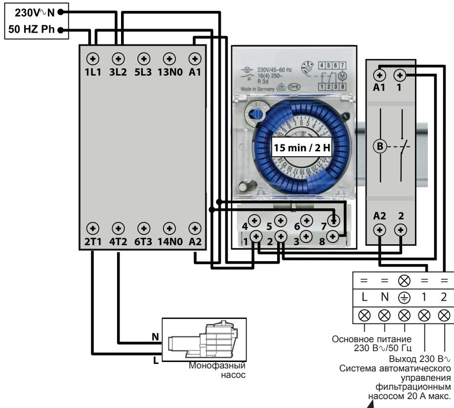
Вне рамок диапазона фильтрации необходимо проводить анализ температуры воды путем регулируемого запуска фильтрационного насоса (15 минут каждые 2 часа). Если во время проведения такого анализа необходим запуск теплового насоса, он включится и зафиксирует приоритет режима подогрева.
