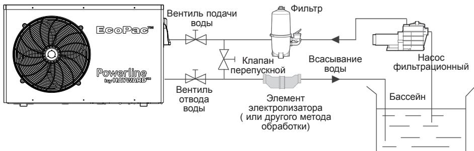
Примечание. Тепловой насос поставляется без какого-либо дополнительного оборудования для обработки или фильтрации воды. Представленные на схеме элементы поставляются фирмой, осуществляющей установку.
