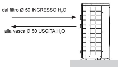
Installare una valvola di "bypass" tra l'ingresso e l'uscita della pompa di calore.
