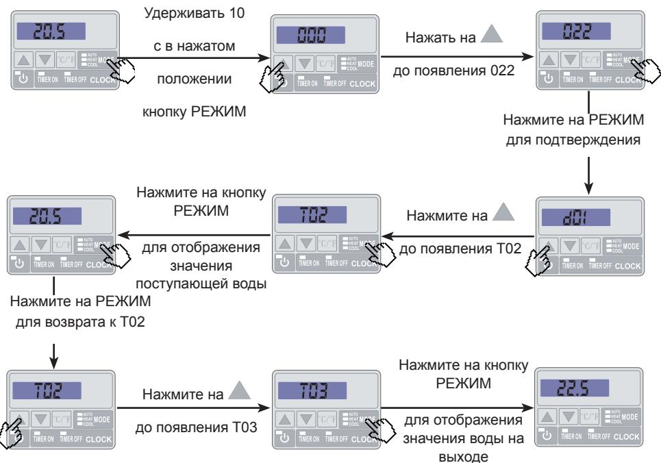
можете проверить правильность регулировки, контролируя отображаемые на командной панели значения температур воды на входе (T02) и выходе (T03).
