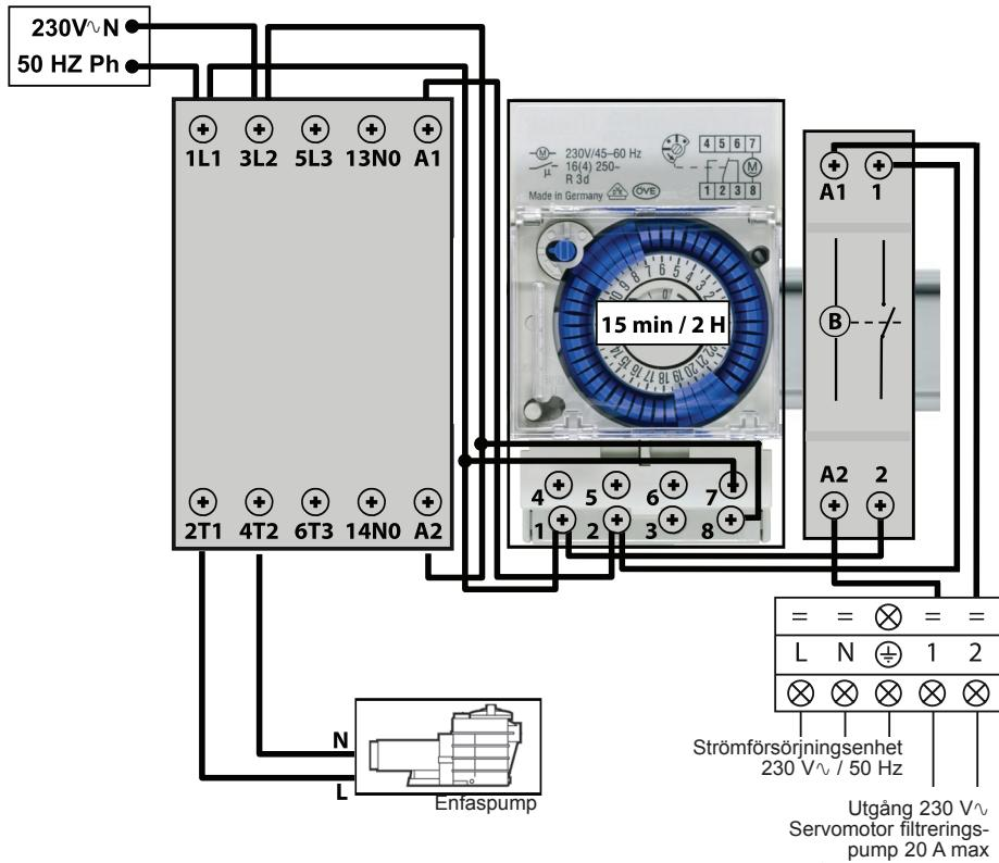
Utanför filtreringsintervallet är det nödvändigt att kontrollera vattentemperaturen genom en regelbunden start av filtreringspumpen (15 minuter varannan timme). Om värmepumpen efterfrågas under denna kontrollperiod kommer denna att starta och att behålla prioritet uppvärmning.
