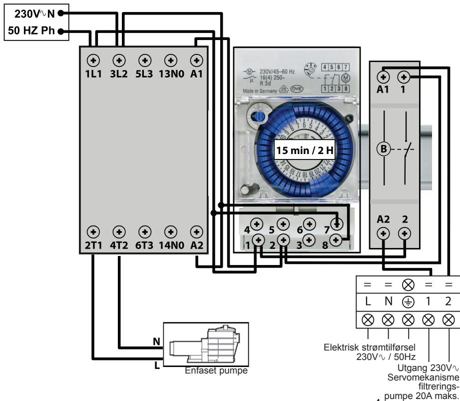
Utenfor filtreringsperiode er det nødvendig å kjøre en analyse av vanntemperaturen ved å starte filtreringspumpen regelmessig (15 min. hver 2. time). Dersom varmepumpen kreves i denne analyseperioden, vil den starte og beholde oppvarmingsprioritet.
