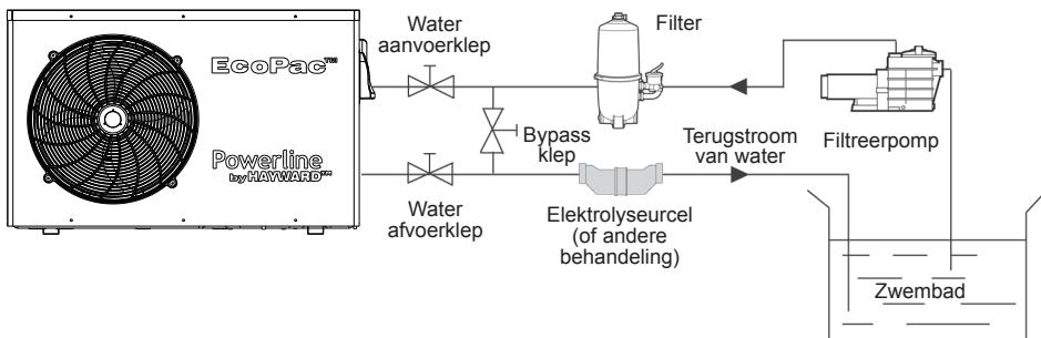
Noot : De warmtepomp wordt zonder enige behandelings- of filtreruitrusting geleverd. De elementen die op de chart staan zijn onderdelen die de installateur moet leveren.
