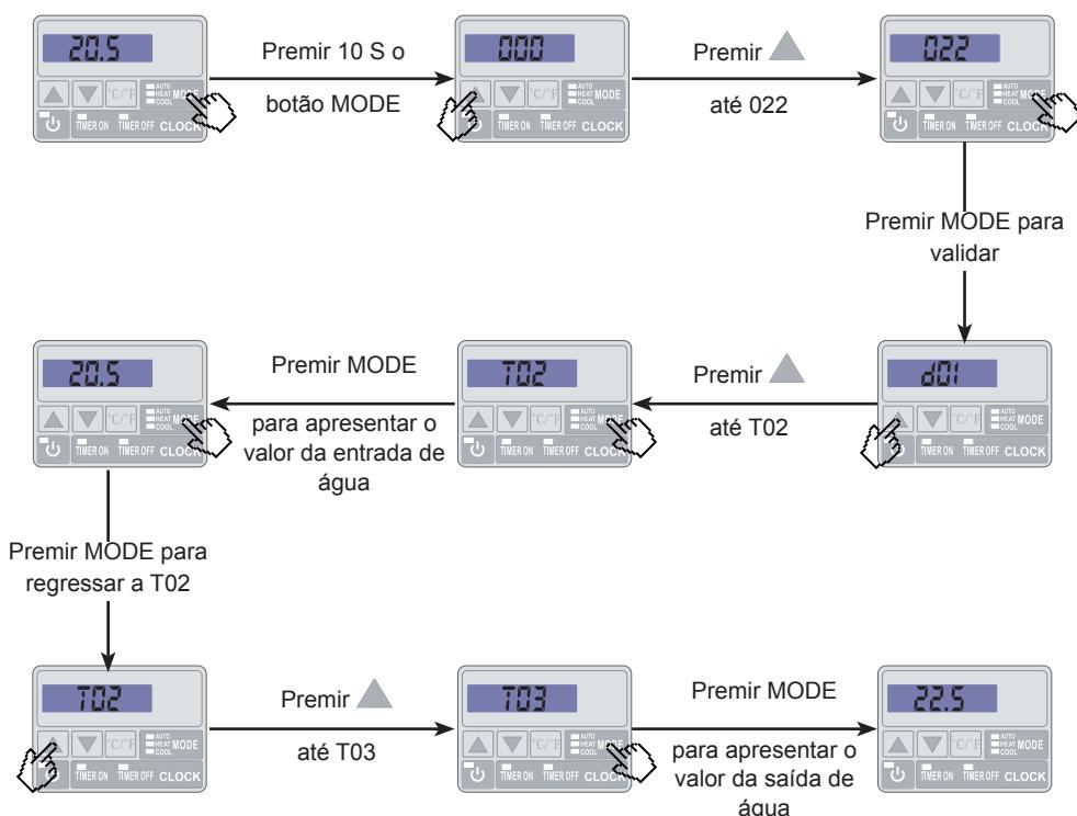
De seguida, regule o seu By-pass para obter uma diferença de 2° C entre T03 e T02 ( $T03 - T02 = \Delta T = 2$ ).
