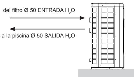
Instale una válvula de derivación entre la entrada y la salida de la bomba de calor.
