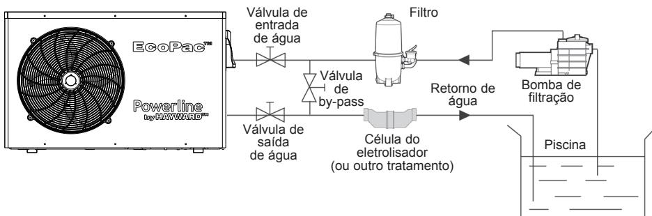
Nota: \_a bomba de aquecimento é fornecida sem qualquer equipamento de tratamento ou de filtração. Os elementos que constam do esquema são componentes a fornecer pelo instalador.
