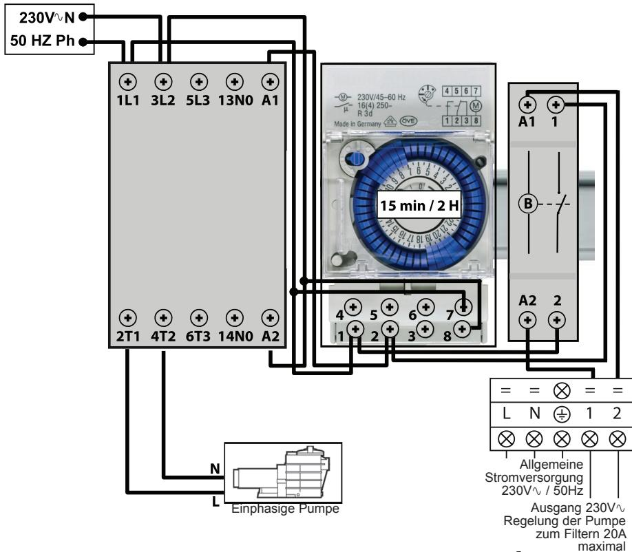
Außerhalb des Filter-Bereichs muss eine Wassertemperatur-Abfrage mittels regelmäßiger Start der Filterpumpe (15 Minuten alle 2 Stunden) erfolgen). Falls die Wärmepumpe in diesem Abfragezeitraum einen Bedarf hat, wird diese mit der Vorrangstellung für die Heizung starten und dies beibehalten.
