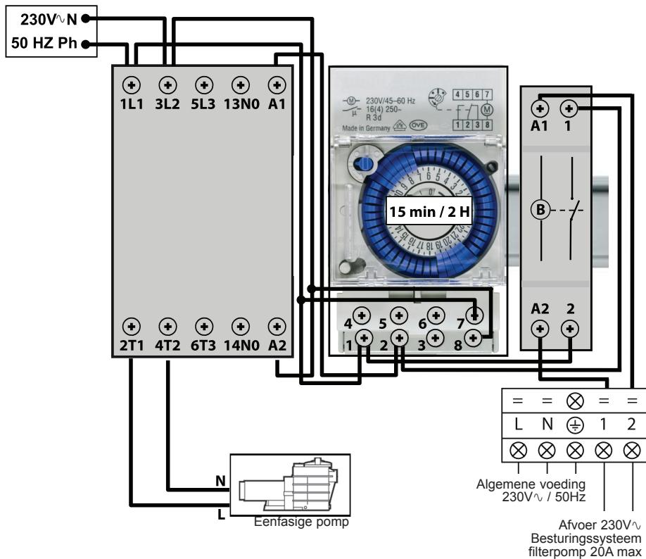
Buiten de filterperiode moet de watertemperatuur gecontroleerd worden door de filtreerpomp regelmatig te starten (15 min om de 2 uur). Indien tijdens deze controleperiode de warmtepomp in aanvraag is, zal deze starten en de verwarmingsvoorrang behouden.
