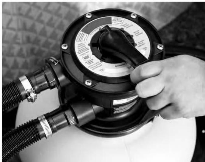
6. Débrancher le tuyau souple de la buse de refoulement.
